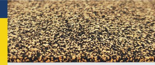
L'Amorim T66 est fabriqué à partir du liège aggloméré et du caoutchouc SBR recyclé – ce produit est livré sur rouleau. L'AcoustiCork T66 de Amorim Cork Composites est une sous-couche acoustique d'une épaisseur de 3 mm qui est mise directement sous la finition du plancher. Le matériau composite de liège et de caoutchouc combine une grande sensibilité d'impression pour éviter d'endommager la finition du plancher et une bonne isolation des bruits d'impact.
