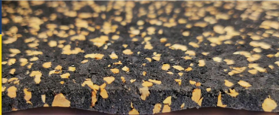
L'Amorim U85 est un tapis d'isolation acoustique livré sur rouleau et fabriqué avec du liège aggloméré et des granulés de polyuréthane recyclé, ce liège et ces granulés sont reliés ensemble avec de la colle latex par un procédé à chaud. La face supérieure de l'isolation a une structure plate ; sa face inférieure a une structure ondulée. L'épaisseur s'élève à 4 mm/2 mm.
