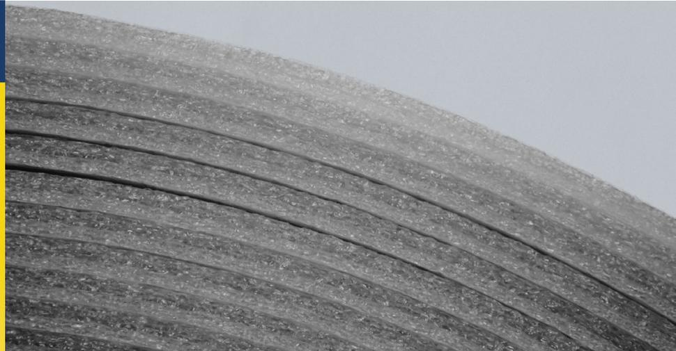
Bandes périphériques en mousse de polyéthylène. Ces bandes sont normalement toujours prescrites en combinaison avec l'Acoustic Reflex. Environ la moitié de la bande périphérique est glissée sous l'isolation du plancher et l'autre moitié contre la paroi. Comme ces bandes ne sont pas épaisses, elles peuvent être pliées facilement sans devoir les entailler.
