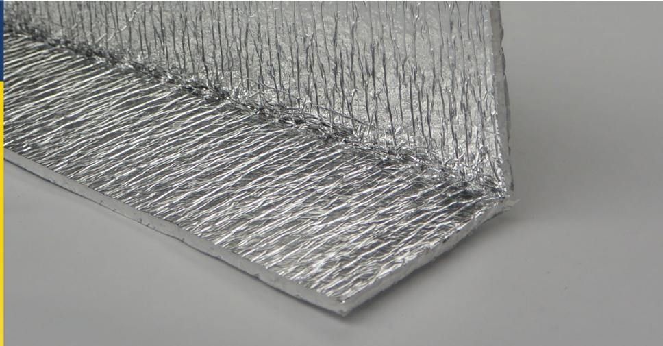
Les bandes périphériques en ThermoFloor Silence consiste en une mousse de polystyrène expansé et canalisée ; ces bandes sont pourvues des deux côtés d'un film PET métallisé. Ces bandes périphériques peuvent ainsi facilement être pliées dans les coins sans que le mousse de polystyrène expansé se détache par morceaux ou soit endommagé. Ces bandes sont normalement toujours prescrites en combinaison avec le ThermoFloor Silence.
