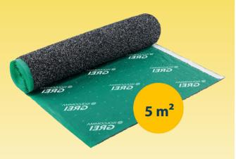
Tapis d'isolation acoustique livré sur rouleau et fabriqué avec des fibres et des granulés de caoutchouc EPDM recyclé, ces fibres et granulés sont reliés ensemble avec de la colle latex par un procédé à chaud. La finition d'un côté de l'isolation est réalisée avec un non-tissé gris qui protège la couche en caoutchouc et empêche la saleté de pénétrer entre les granulés de caoutchouc.
