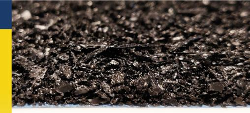
Tapis d'isolation acoustique livré sur rouleau et fabriqué avec des fibres et des granulés de caoutchouc SBR recyclé, ces fibres et granulés sont reliés ensemble avec de la colle latex par un procédé à chaud. La finition d'un côté de l'isolation est réalisée avec un nontissé bleu qui protège la couche en caoutchouc et empêche la saleté de pénétrer entre les granulés de caoutchouc.
