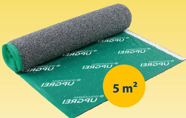
Tapis d'isolation acoustique livré sur rouleau et fabriqué avec des granulés de caoutchouc EPDM recyclé liés à une couche de fibres de polyester. La finition d'un côté de l'isolation est réalisée avec un non-tissé vert qui protège la couche en caoutchouc et empêche la saleté de pénétrer entre les granulés de caoutchouc.
